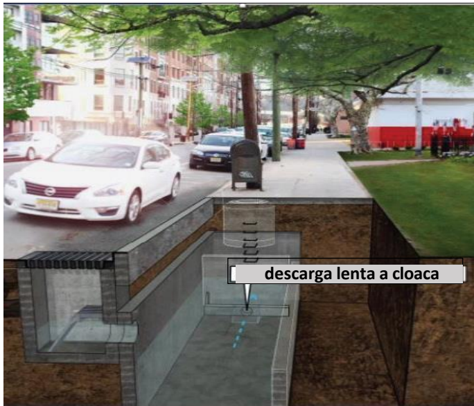
Fig. 4-21: Representación del sitio típico de ROW con cisternas de captura (imagen a la izquierda) y representación detallada de la típica cisterna de captura y descarga subterránea de ROW.
