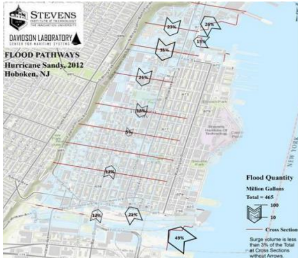
Fig. 4.4: Rutas de inundación en Hoboken, NJ. En colaboración con el Estado, el Stevens Institute of Technology viene creando y validando modelos que puedan ayudar a captar las rutas de inundación. Estos modelos pueden proporcionar información sobre los riesgos locales y fundamentar la selección de medidas adecuadas de reducción de riesgos; así como caracterizar los beneficios y la eficacia de las diferentes opciones. La evaluación llevada a cabo por el Estado sobre las rutas de inundación en Hoboken, Nueva Jersey (ver figura) por ejemplo, destaca la labor en curso del Estado para identificar estrategias efectivas en entornos urbanos densamente poblados. Fuente: Estado de Nueva Jersey en colaboración con Stevens Institute of Technology.
